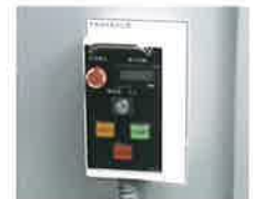
▼手元操作箱 制御装置と離れた場所からプログラム起動・停止を実施するための操作箱です。
