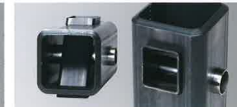
軟鋼パイプ t2mm, t9mm (アシストガス:酸素) ステンレス鋼パイプ t2mm (アシストガス:窒素)
