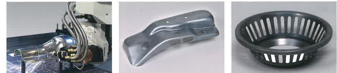
アルミニウム合金 t3.0mm (アシストガス:エア)
