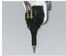
▼溶接ヘッド 放物面鏡による集光系を備え溶接加工が可能となります。
