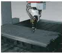
▼平板加工パレット 手動式ワーククランプと端材受け引き出しを備えたパレットです。
