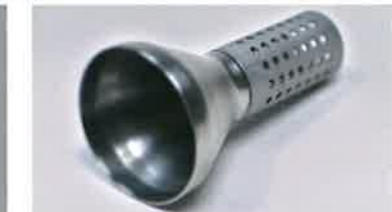
ステンレス鋼パイプ t2mm メッキ鋼パイプ t2mm 突き合わせ溶接 (アシストガス:アルゴン)
