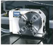
▼NCターンテーブル 6軸同期制御によるパイプなどの加工が可能となります。
