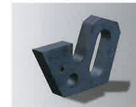
軟鋼 t16mm (アシストガス:酸素)
