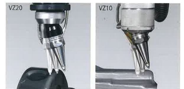
バネによって衝撃を軽減。指でヘッド先端を引っ張り復元します。過度な衝撃が加わった場合、特定部品の破損によって衝撃を吸収するシアピン方式も備えています。
